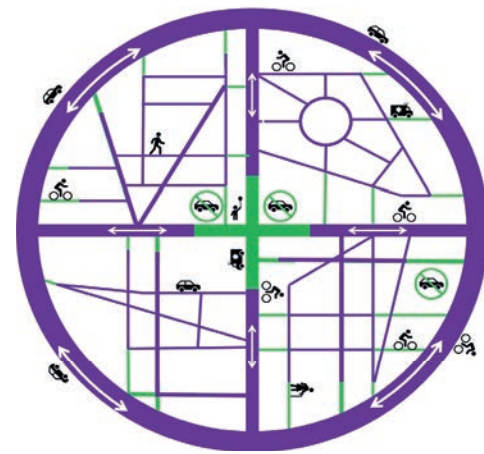
Schematische Darstellung des Houten Modells. Alle Verkehrsteilnehmer teilen sich den violetten Verkehrsraum. Vom grünen Verkehrsraum sind PKW ausgeschlossen.
